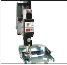
Der optionale Automatikschweißkopf SK-5AP eignet sich speziell für den Einsatz in der Serienfertigung
